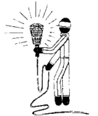
PORTALAMPARAS CON MANGO DE MATERIAL AISLANTE
